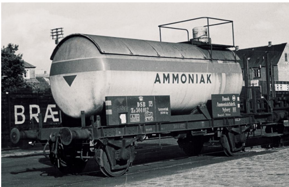
Således endte vognene med at se ud, efter at hele beklædningen var fjernet og et nyt soltag monteret. Foto.: Arne Kirkeby. Arkiv.: OMJK.
