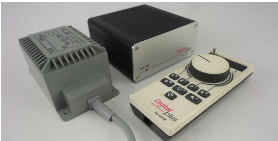
Digitalt sæt fra Lenz, der består af transformator, centralenhet og kørekontrol. Så er man kørende.
