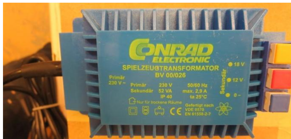
Eksempel på en kraftig transformator, der kan tilsluttes for både 12 og 18 volt
